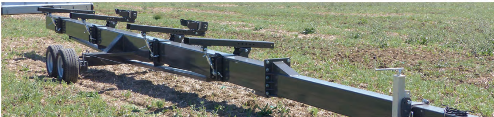
PORTE-COPE MOISSONNEUSE BATTEUSE système de freinage par inertie, hydraulique et frein de service
